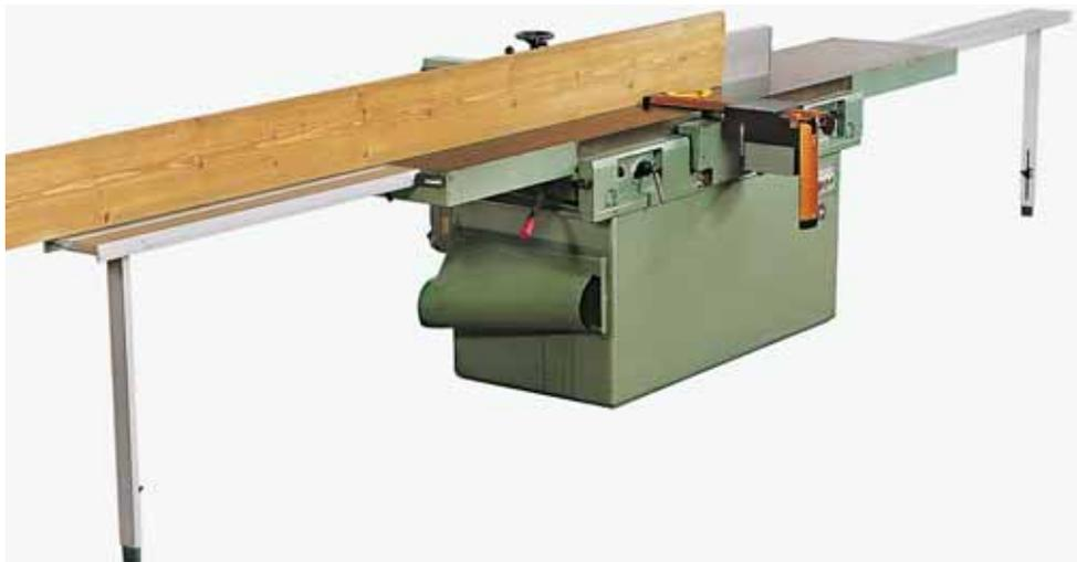
La rallonge de table Aigner est un accessoire indispensable pour le moulurage discontinu. Elle rend superflue la présence d'un assistant pour l'usinage de pièces longues et permet également de fixer différents dispositifs tels que des butées transversales, fraise-cercles ou autres.
