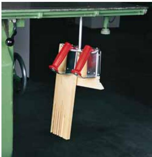
Ce crochet double est particulièrement utile pour suspendre des poussoirs. Il permet, par exemple, d'accrocher un poussoir longitudinal et un poussoir latéral à une scie circulaire à table. Cet accessoire se fixe sur la table de la machine (taroudage M10).
