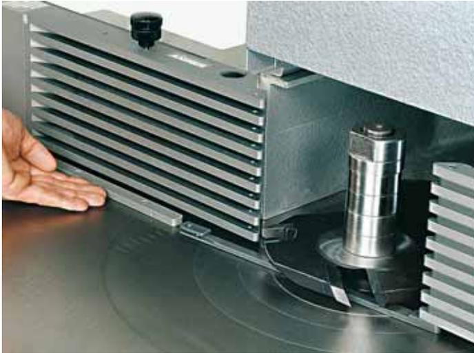
La barre de treillis Aigner permet d'obturer l'évidement inférieur de la moitié gauche du guide intégral et de garantir une surface de guidage continue dans cette zone.
