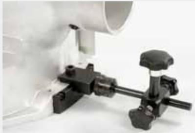
**Réf. 9538** (lunettes d'appui et dispositif de réglage de précision)
