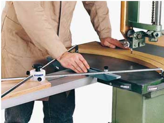
Découpage exact de segments de cercle sans retouche ni traçage préalable. L'échelle graduée permet un réglage rapide et précis du rayon désiré.
