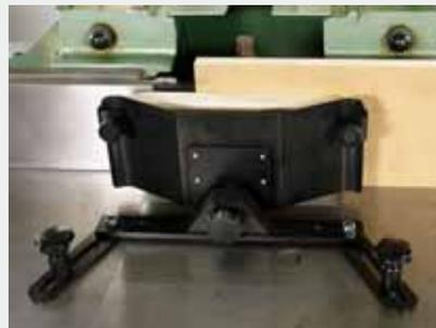
Accessoire recouvrant l'outil et permettant de presser la pièce usinée contre le guide. Possibilité d'introduire une plaque de guidage dans le dispositif de pivotement.
