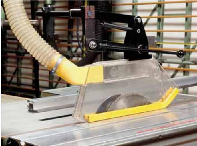
Tuyaux souples et robustes en plastique transparent, très résistants à l'usure, avec armature intégrée.
