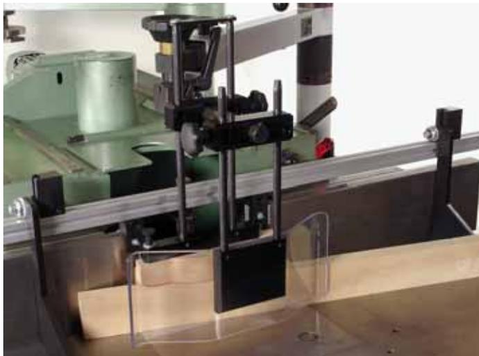
La butée présentée ci-après assure une protection optimale pour tous les travaux de moulurage discontinu. Ce dispositif réglable permet un ajustage rapide en fonction de la longueur des pièces usinées. Celles-ci peuvent être aisément insérées et extraites de la machine.
