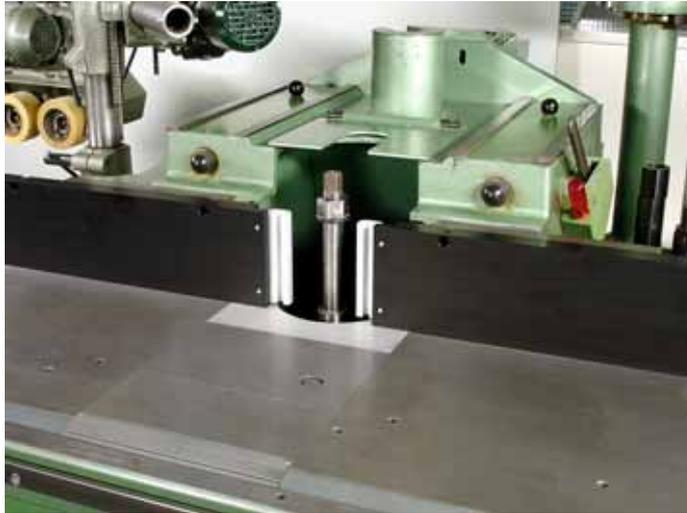
Ces plaques se montent sur tous les guides existants grâce à une fixation par excentrique de serrage. Elles garantissent un usinage précis des pièces. Les plaques de guidage sont en aluminium anodisé. Les rails profilés avec rainure en T sont interchangeables.
