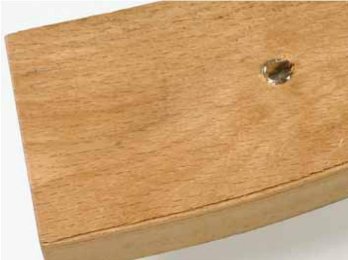
La pointe a un filetage M8. Le gabarit maintient la pièce à usiner au moyen des pointes.
