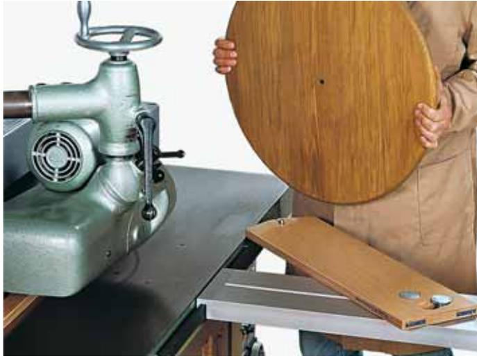
Facile à utiliser, le fraise-cercle permet de fraiser et de découper des arcs en plein cintre et des disques avec une grande précision sans retouche ni traçage préalable.
