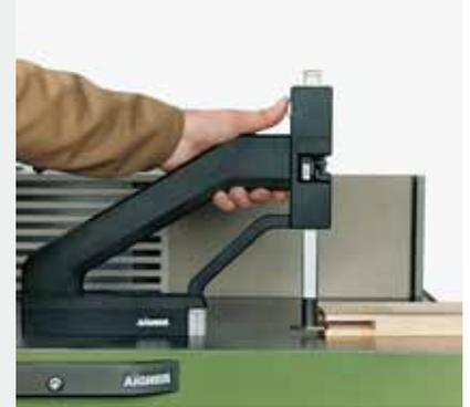
Ce distomètre offre un vaste champ de possibilités: il permet par exemple de mesurer rapidement et très précisément la hauteur et la profondeur de réglage des outils ainsi que l'épaisseur et la profondeur des rainures, des alésages, des profils et des évidements des pièces à usiner.
