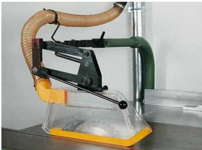
La cape de protection et d'aspiration S 91 pour scies circulaires offre une excellente protection contre les risques de blessures aux mains par contact avec la lame en rotation. Elle recouvre entièrement la lame et la pièce usinée. Equipée d'un dispositif de réglage parallèle et dotée d'un tuyau de 80 mm de diamètre intérieur, elle se raccorde aisément au dispositif d'aspiration des copeaux.
