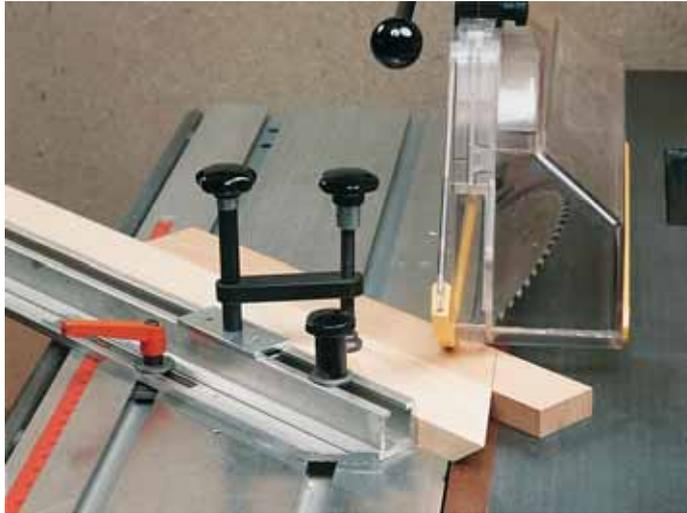
Ce dispositif de serrage constitue un accessoire indispensable pour fixer une cale au guide transversal. Il peut être monté sur la plupart des guides transversaux.
