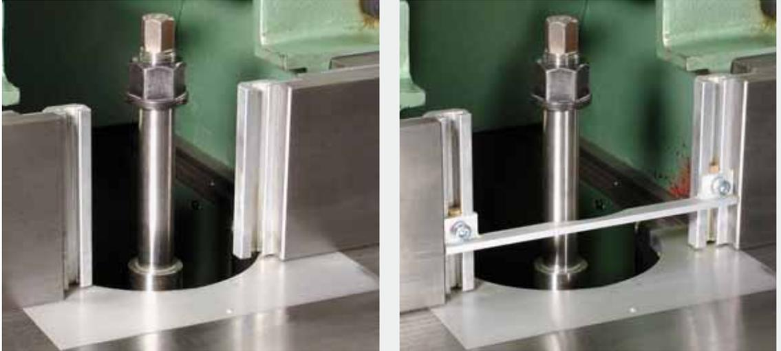
Les rails profilés pour guide servent à maintenir les lèvres de guide, la planchette de fraisage et les barrettes. Ces accessoires garantissent un guidage optimal des pièces lors des travaux de fraisage sur toupies.
